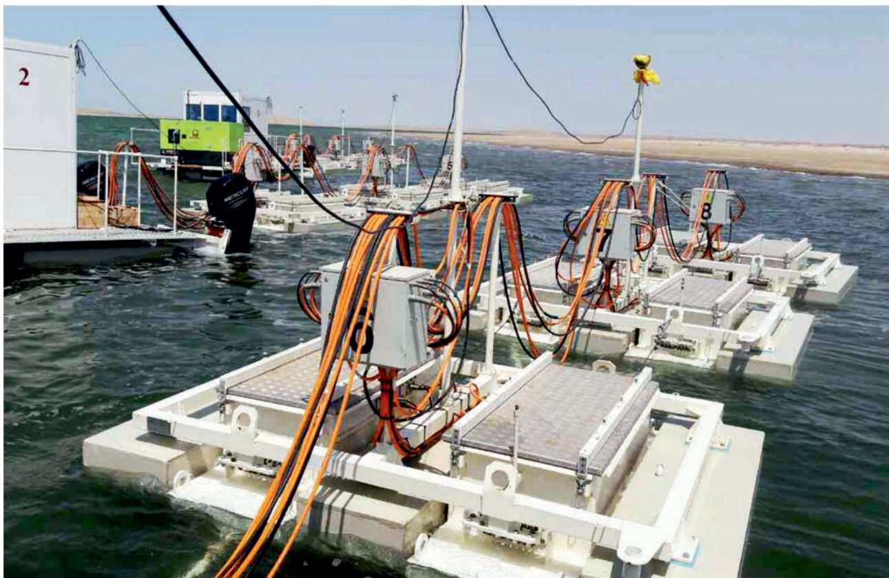
Применение импульсного источника сейсмического сигнала на плавающей платформе, приводимой в движение лодочными моторами для отработки площади на мелководье (глубина воды до 3 м)
