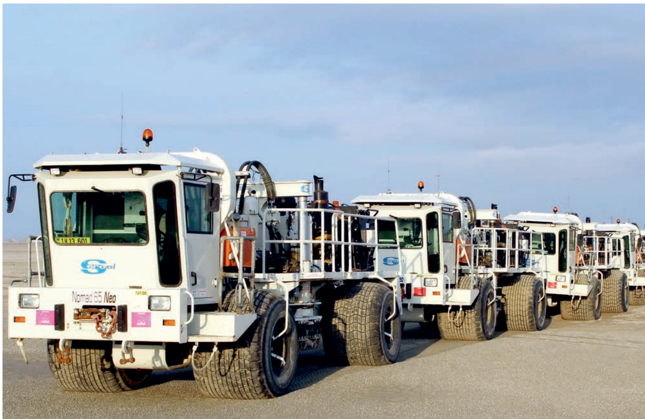
Возбуждение сейсмического сигнала с использованием вибрационных источников новой модификации Nomad 65 NEO производства компании Sercel (Франция)
