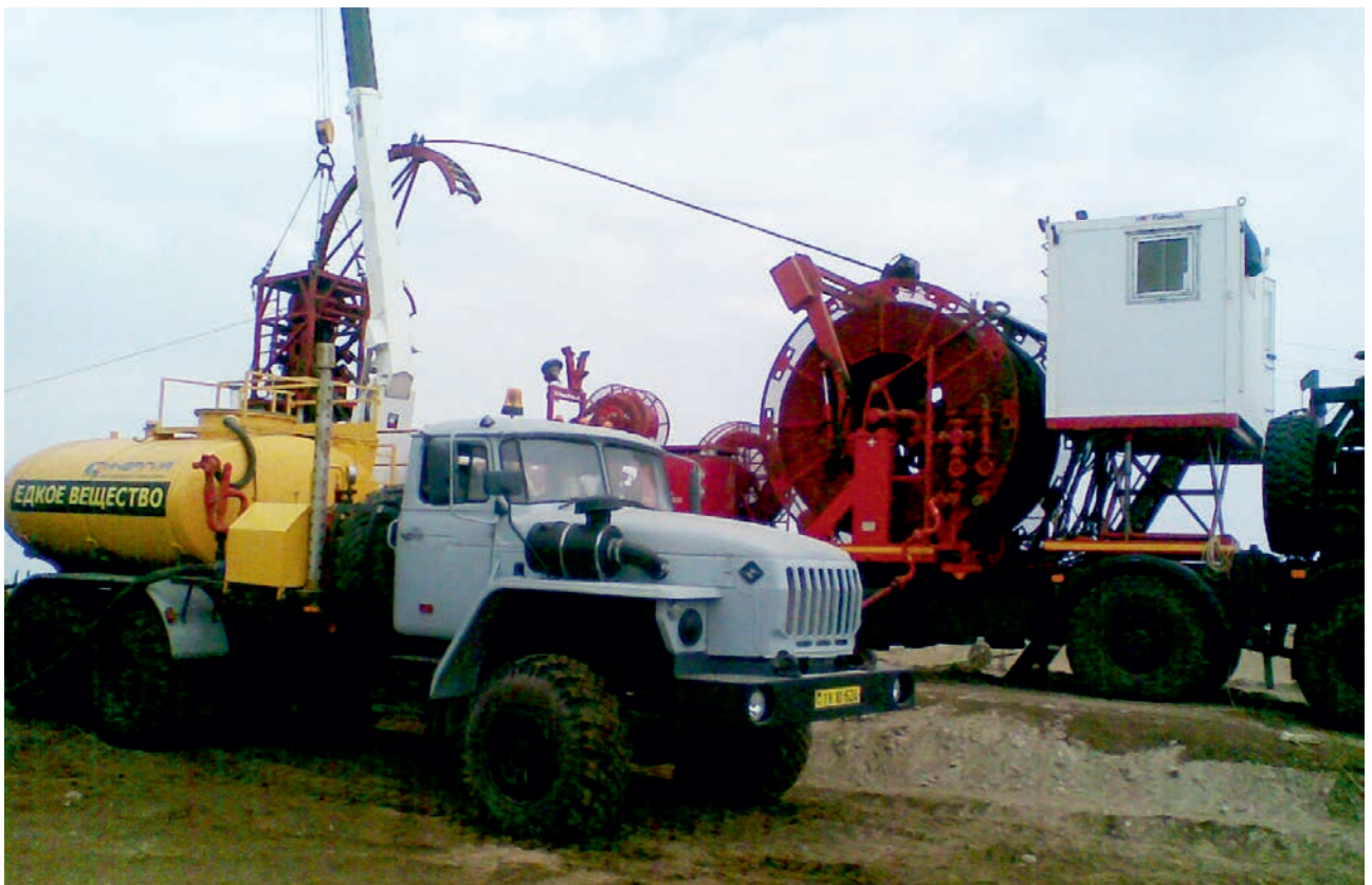
Месторождение Готурдепе: выполнение работ по кислотной обработке пласта с помощью колтюбинговой установки и насосной установки в кислотном исполнении.
