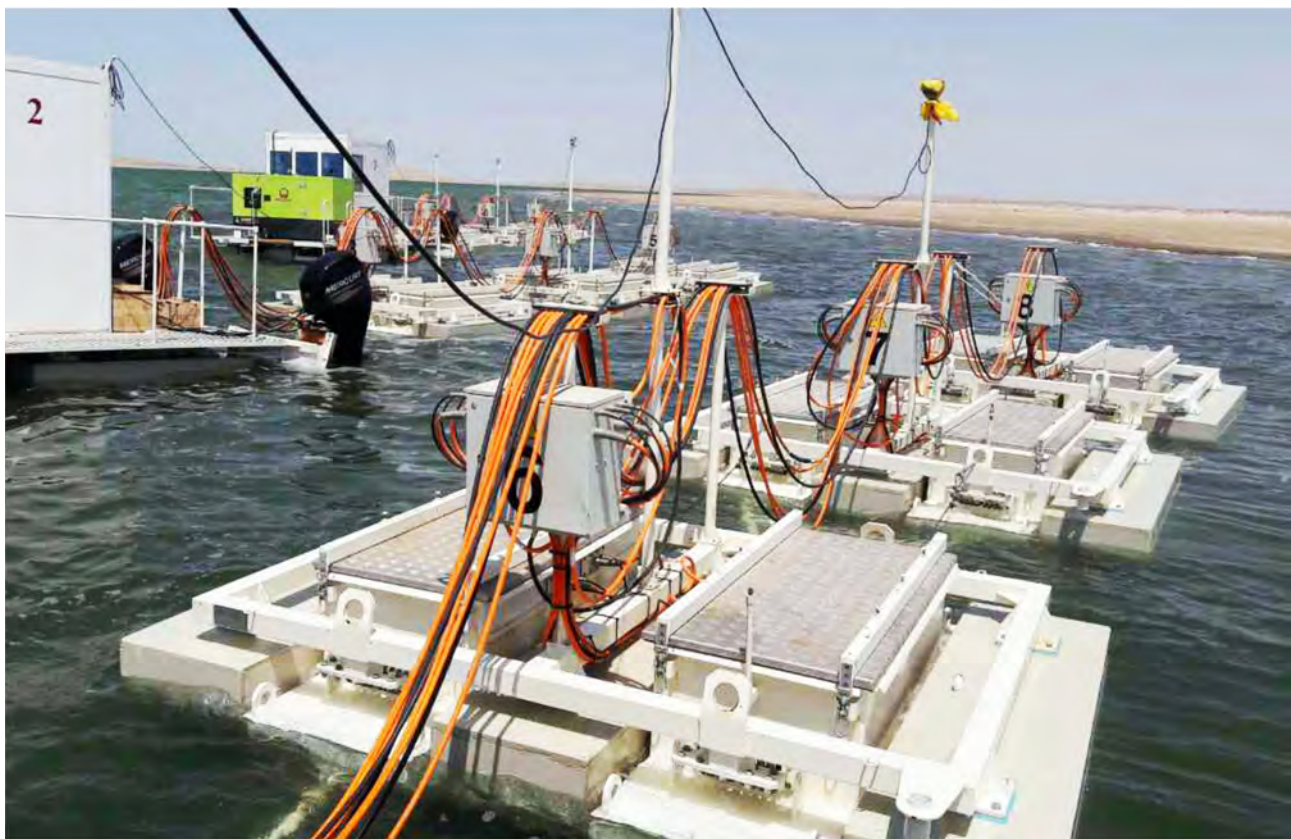
Применение импульсного источника сейсмического сигнала на плавающей платформе, приводимой в движение лодочными моторами для отработки площади на мелководье (глубина воды до 3 м) на месторождении Северное Готурдепе
