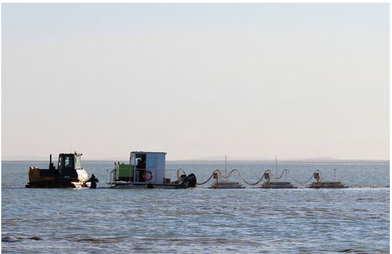
Полевые работы по 2D-сейсморазведке, включающей сушу и мелководье
