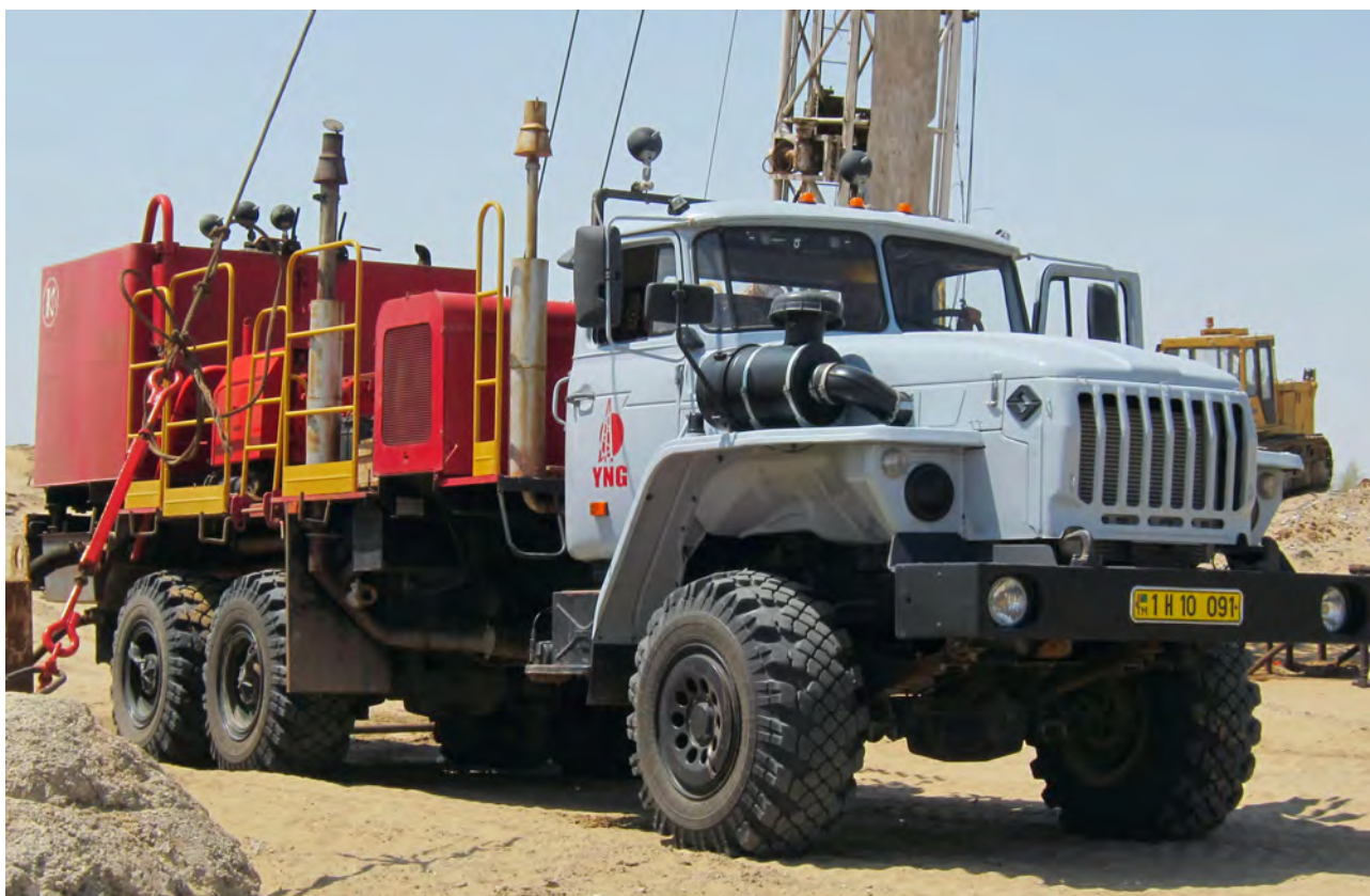
Месторождение Барсагельмес: работа насосного агрегата при выполнении работ по ограничению водопритоков к забою скважины.
