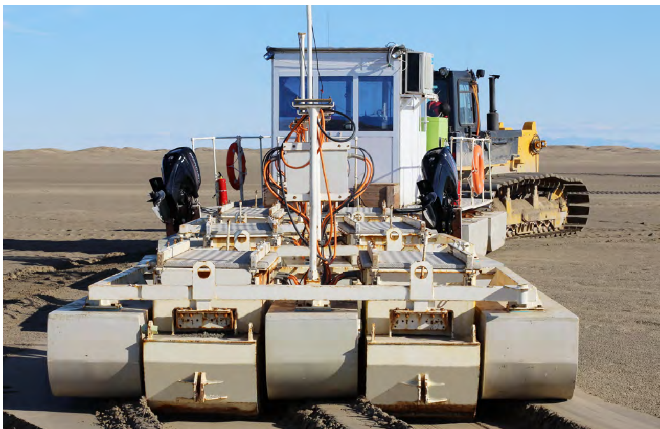
Площадь Дарджа: отработка переходной зоны с применением импульсного источника сейсмического сигнала на плавающей платформе, буксируемой бульдозером (в болотном исполнении)
