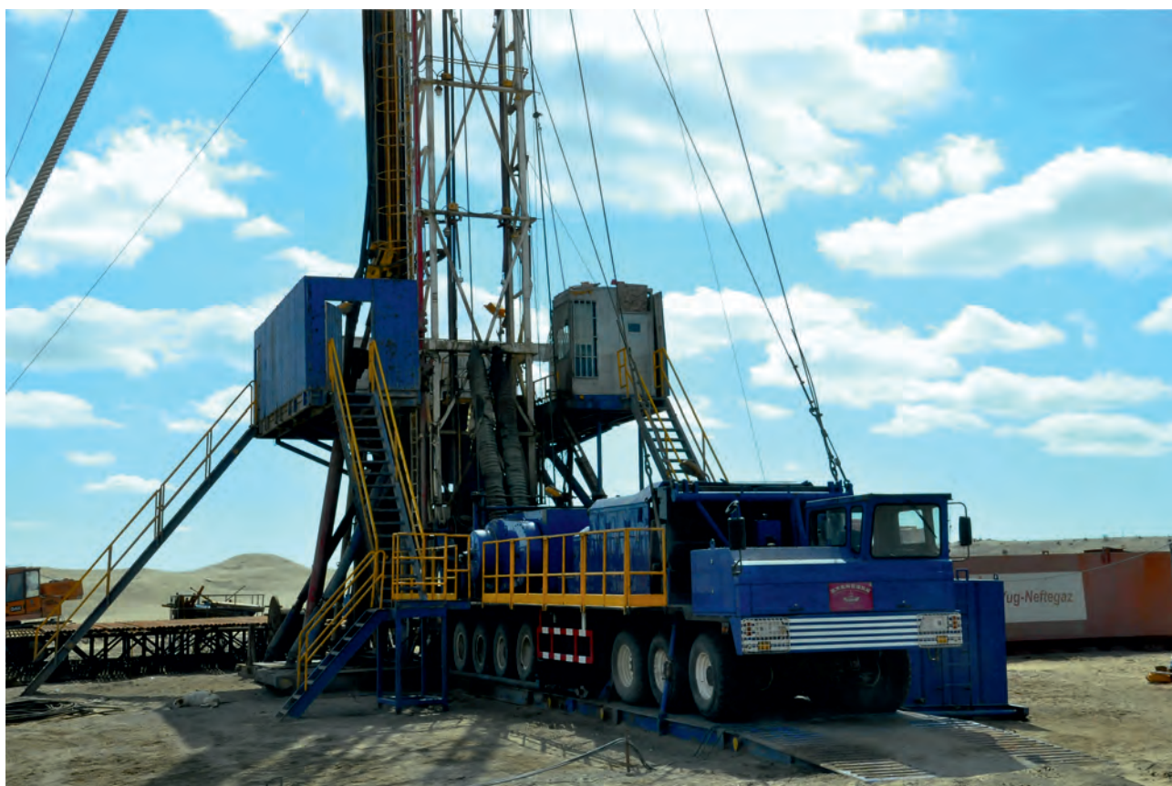
Месторождение Готурдепе: резка бокового ствола мобильной буровой установкой ZJ-40 грузоподъемностью 225 т
