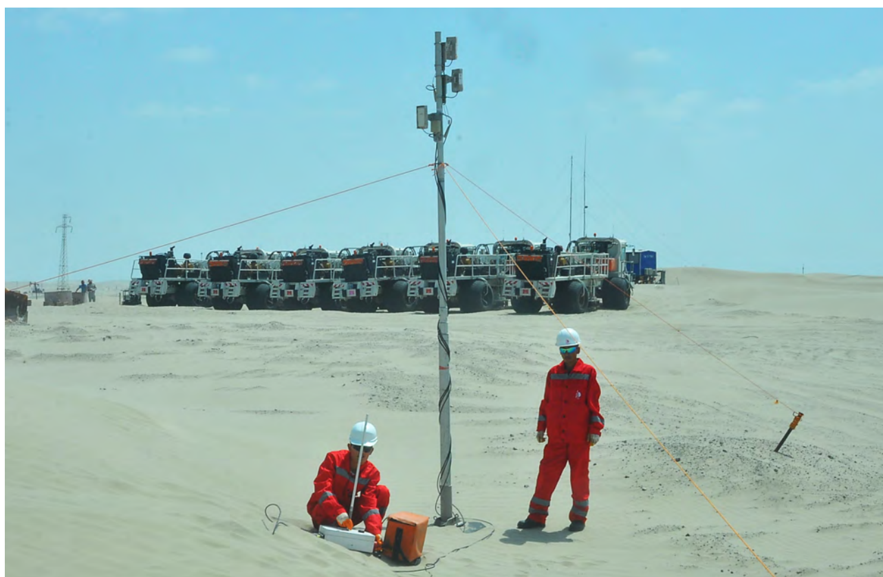
Месторождение Барсагельмес: Тестирование и настройка приемо-передающей системы Radio-Link беспроводной системы регистрации сейсмических данных RTS2 производства компании Wireless Seismic (США)
