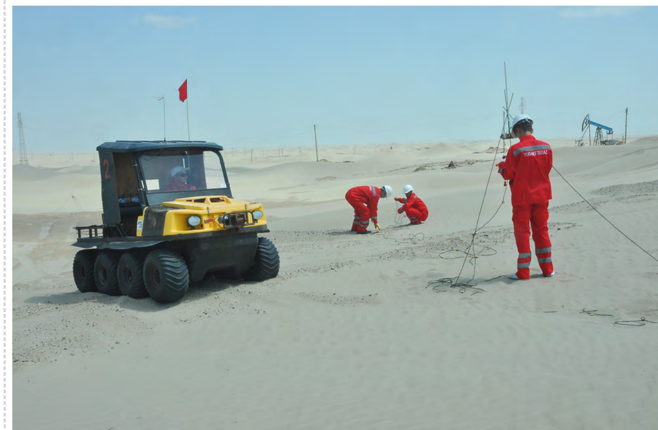
Месторождение Барсагельмес: Установка полевых модулей WRU беспроводной системы регистрации сейсмических данных RTS2 производства компании Wireless Seismic (США)
