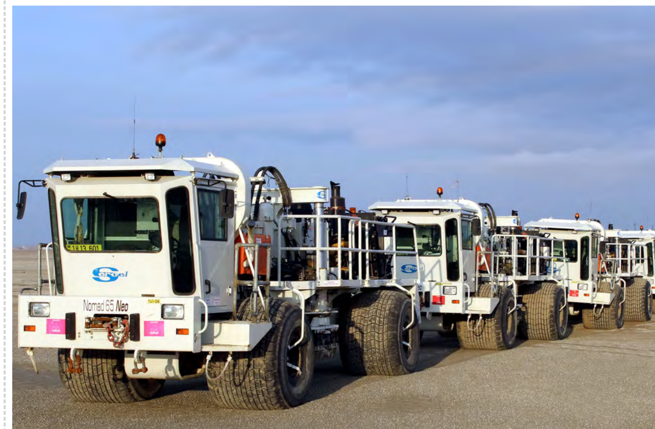
Возбуждение сейсмического сигнала с использованием вибрационных источников новой модификации Nomad 65 NEO производства компании Sercel (Франция)
