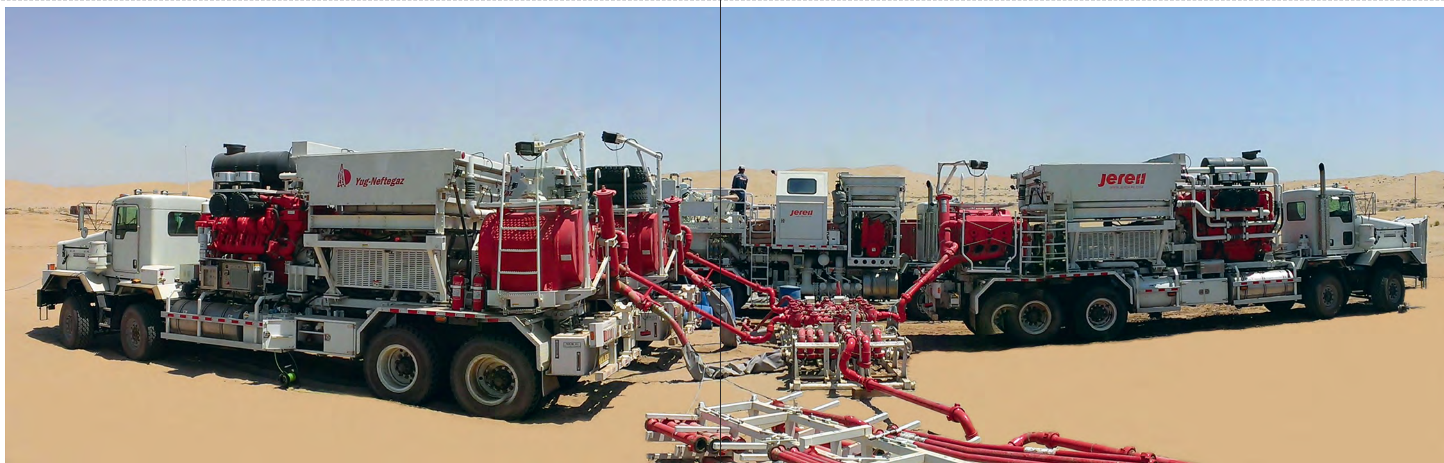
Месторождение Готурдепе: выполнение работ по гидравлическому разрыву пласта флотом ГРП компании Yug-Neftegaz Private Limited
