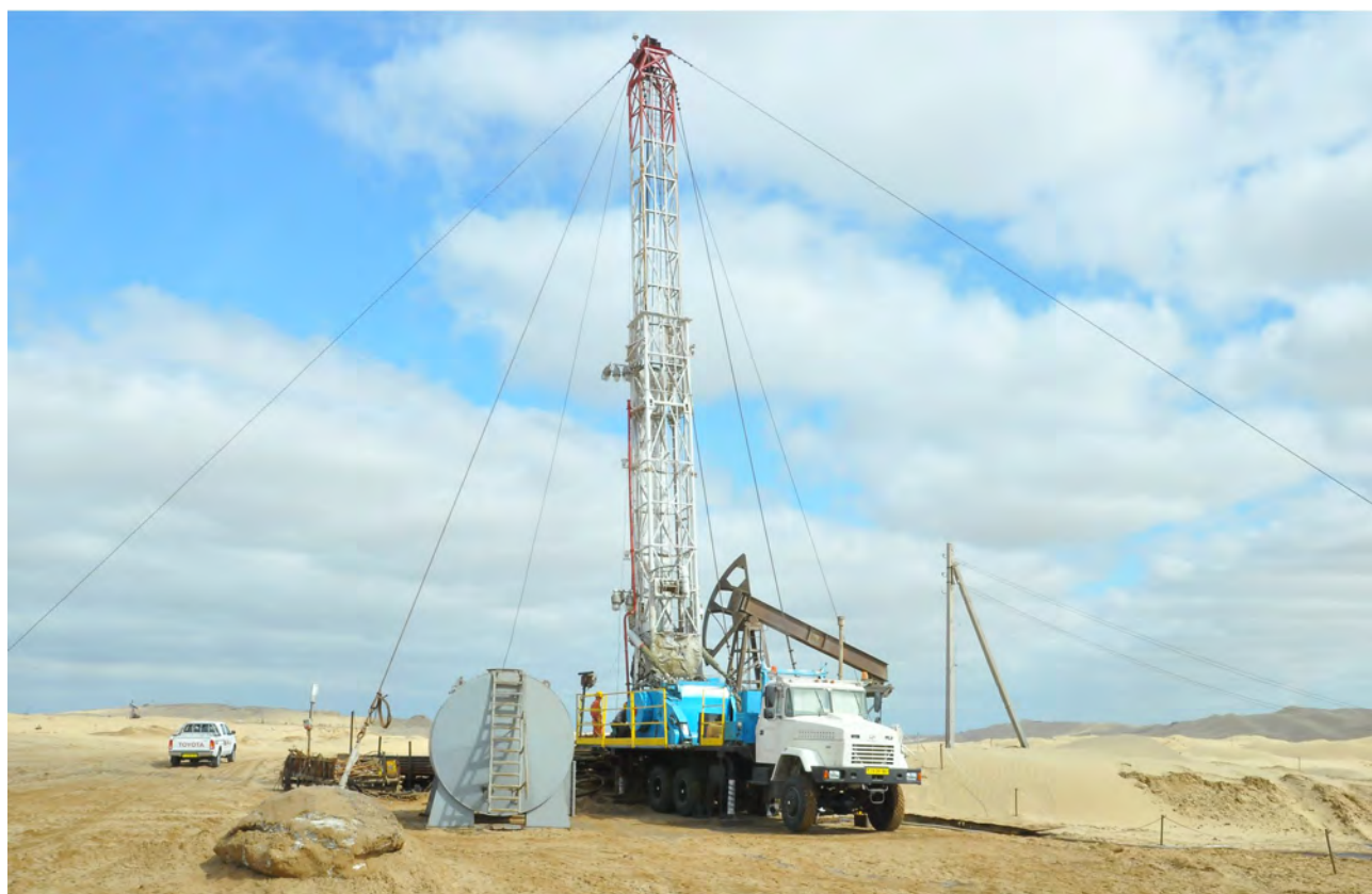
Месторождение Готурдепе: выполнение работ по ограничению водопритоков к забою скважины с применением подъёмной установки грузоподъёмностью 80 т
