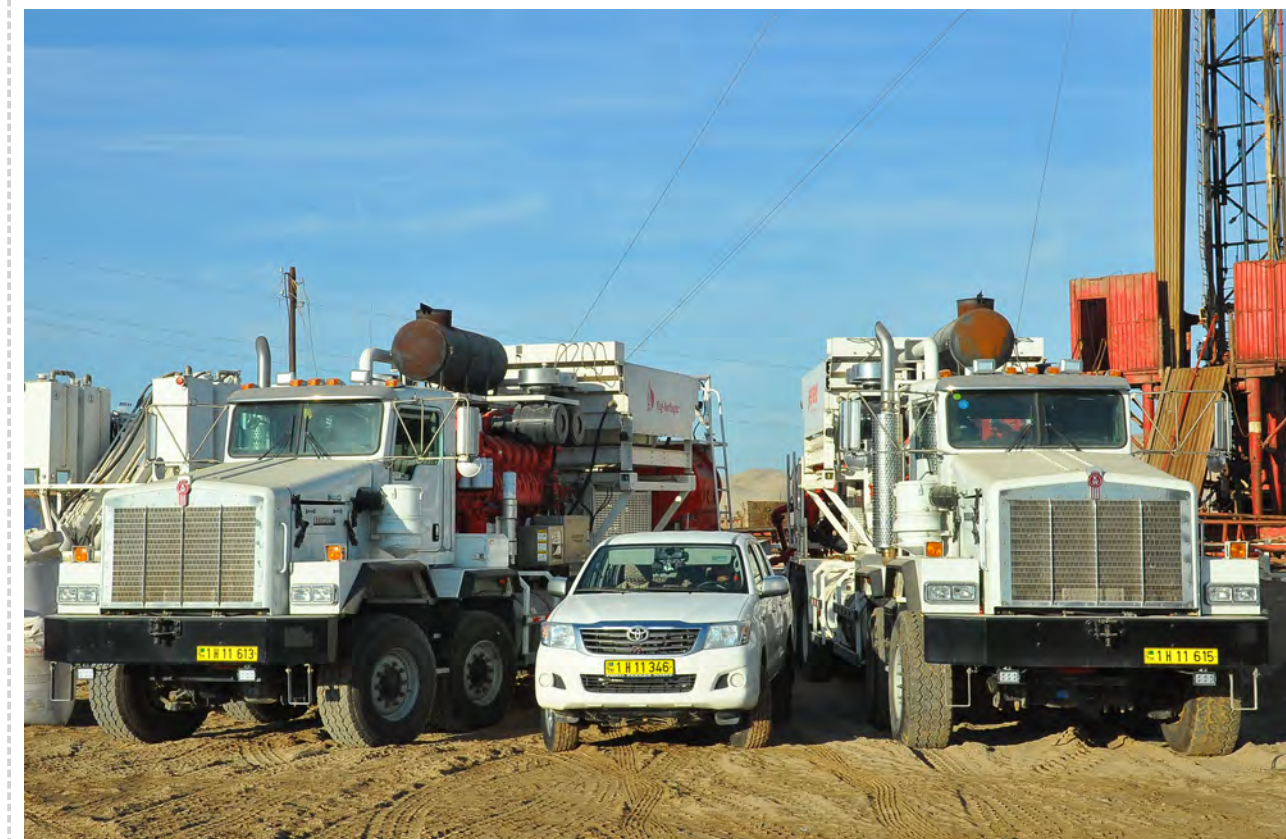
Месторождение Барсагельмес: выполнение работ по гидropескоструйной перфорации
