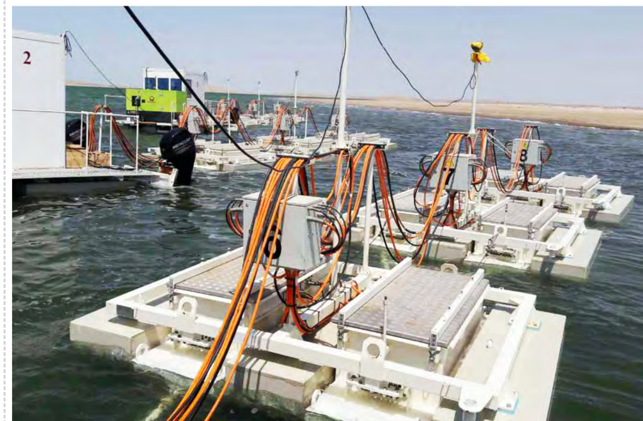
Применение импульсного источника сейсмического сигнала на плавающей платформе, приводимой в движение лодочными моторами для отработки площади на мелководье (глубина воды до 3 м)
