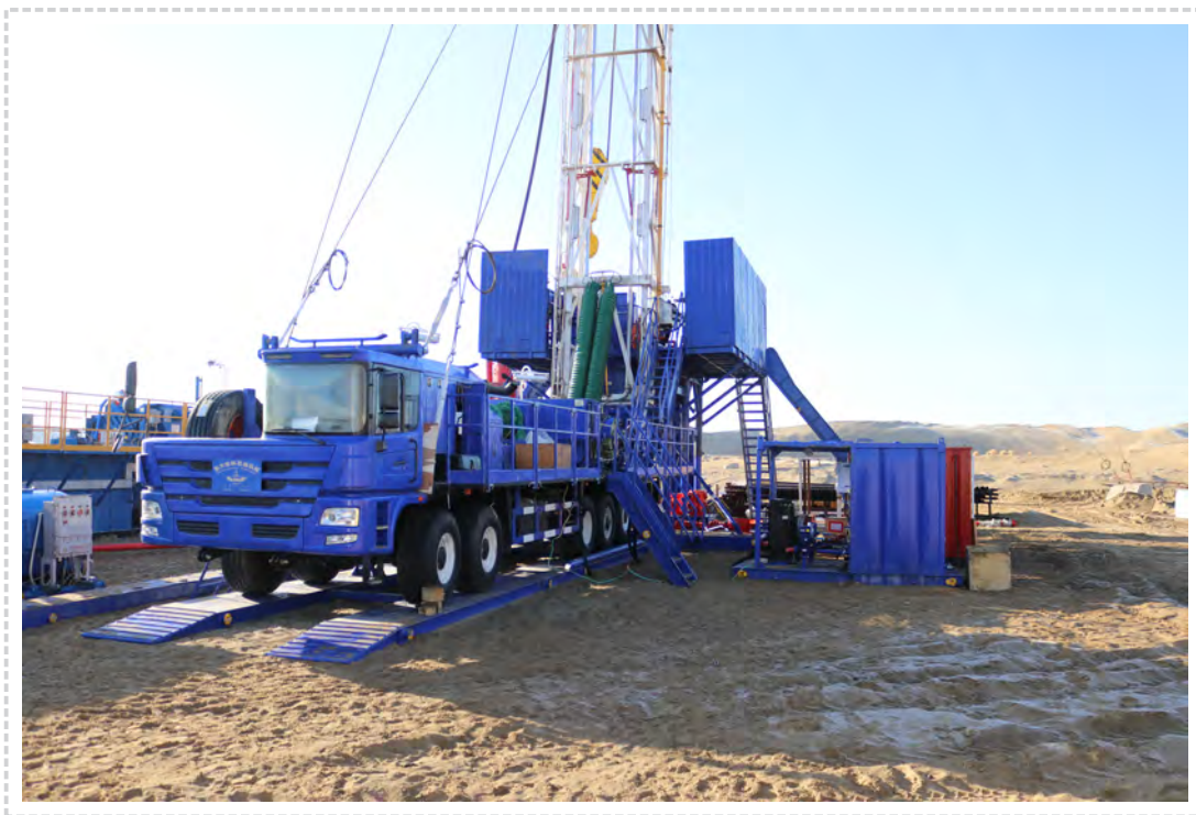
Буровая установка ZJ-15 (100 т)
