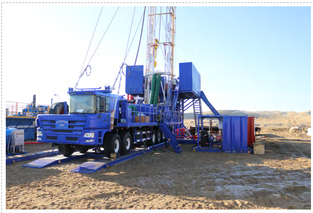
Буровая установка ZJ-15 (100 т)
