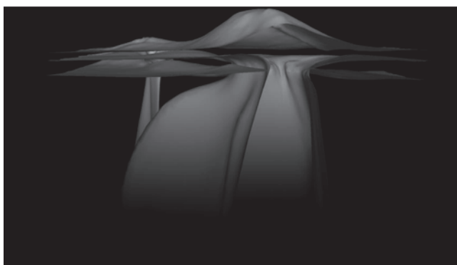
Объемное изображение поверхностей соляного штока
