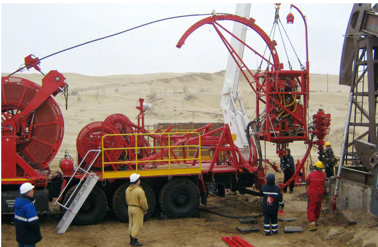
Месторождение Кеймир: выполнение работ по кислотной обработке пласта с помощью колтюбинговой установки МК30Т
