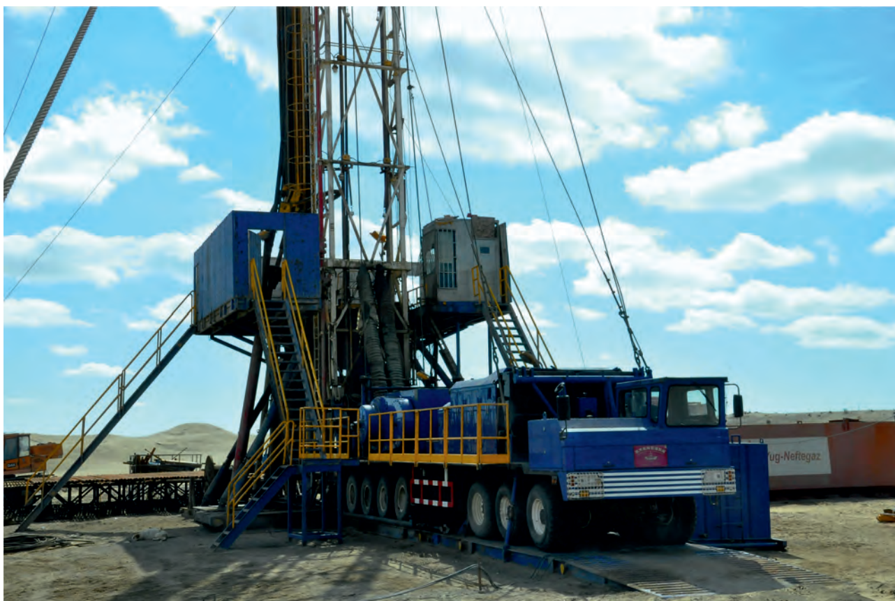
Месторождение Готурдепе: зарезка бокового ствола мобильной буровой установкой ZJ-40 грузоподъемностью 225 т
