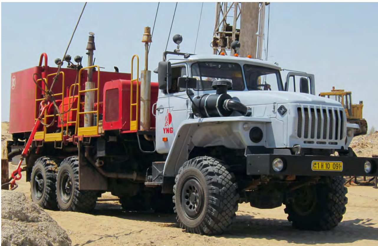
Месторождение Барсагельмес: работа насосного агрегата при выполнении работ по ограничению водопритоков к забою скважины.
