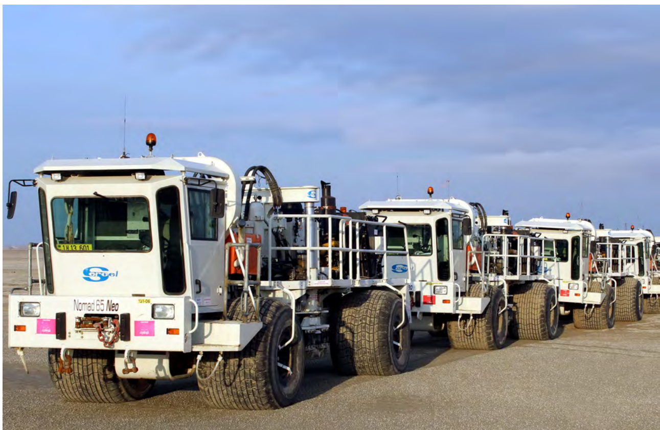
Возбуждение сейсмического сигнала с использованием вибрационных источников новой модификации Nomad 65 NEO производства компании Sercel (Франция) на месторождении Готрдепе
